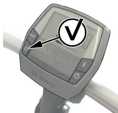
Image 21 : Mettre l'affichage sous et hors tension
