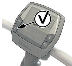
Afbeelding 21: Het display aan- en uitzetten
