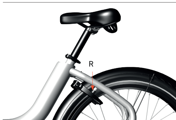
Abbildung 37 : Überprüfen der Schlossgummis
