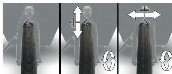
Abbildung 34 : Prüfen des Seitenschlags
