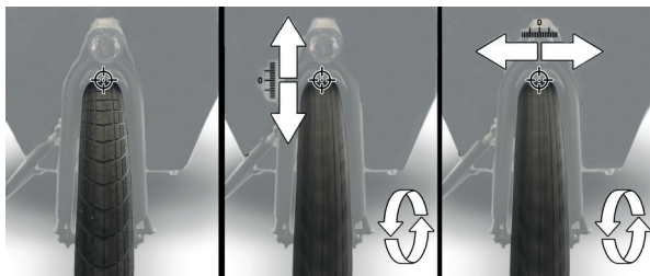
Image 34 : Vérification du décalage de la roue
