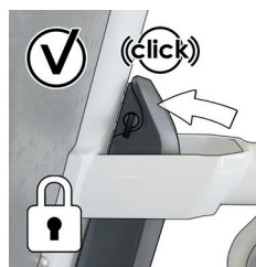
Image 18 : Batterie correctement installée
