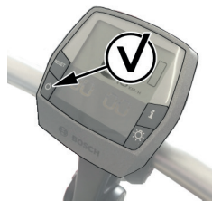
Abbildung 21 : Ein- und Ausschalten des Displays
