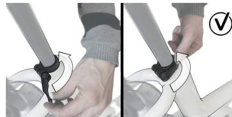
Abbildung 8 : Schließen des Schnellspanners der Sattelstütze
