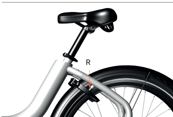
Image 37 : Vérification des caoutchoucs de verrouillage
