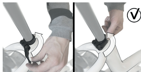
Afbeelding 8: Sluit de snelspanner zadelpen
