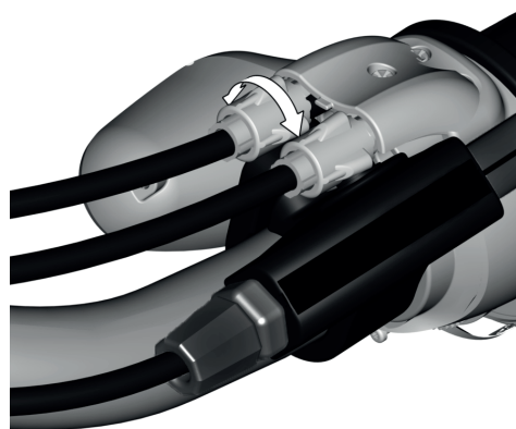
Image 40 : Réduire ou augmenter le jeu du câble en tournant le cylindre sur la poignée de changement de vitesses
