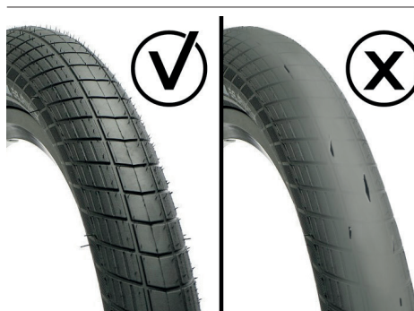
Image 33 : Usure des pneus
