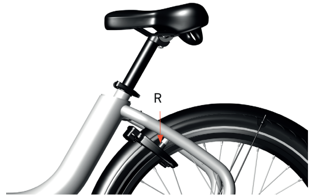
Afbeelding 37: De slotrubbers controleren
