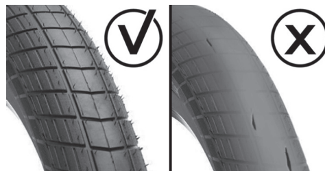
Image 33 : Usure des pneus avant et arrière
