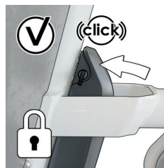
Image 18 : Batterie correctement installée
