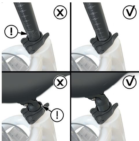
Image 7 : Insertion maxi et mini de la tige de selle
