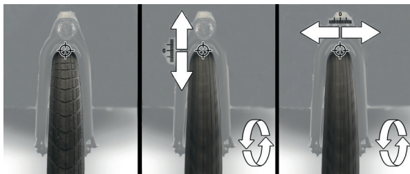
Image 34 : Vérifier le voile de la roue arrière
