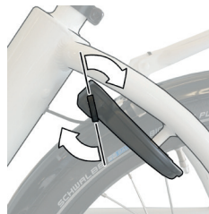
Abbildung 25: Drehen Sie den Schlüssel um 20 bis 30 Grad im Uhrzeigersinn.
