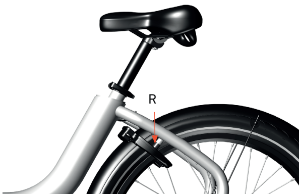
Image 38 : Vérification des caoutchoucs de verrouillage
