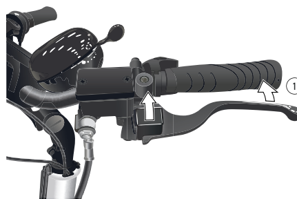
Image 23 : Desserrer le frein de stationnement
