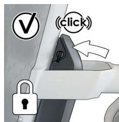
Abbildung 18: Klickgeräusch signalisiert ordnungsgemäß eingesetzten Akku
