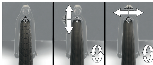
Afbeelding 34: De centrering van het achterwiel controleren
