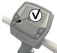
Afbeelding 21: Het display aan- en uitzetten
