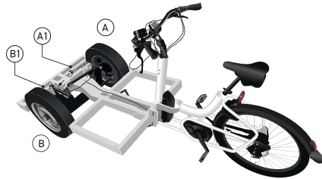
Abbildung 32: Vorderreifen ausbauen und einsetzen
