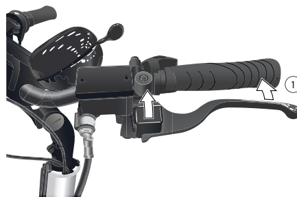
Afbeelding 23: Ontgrendelen van de parkeerrem
