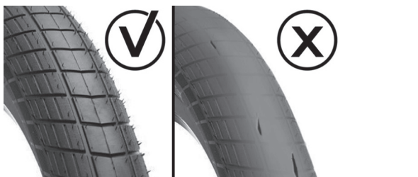
Abbildung 33: Reifenschleiß an Vorderreifen und Hinterrad
