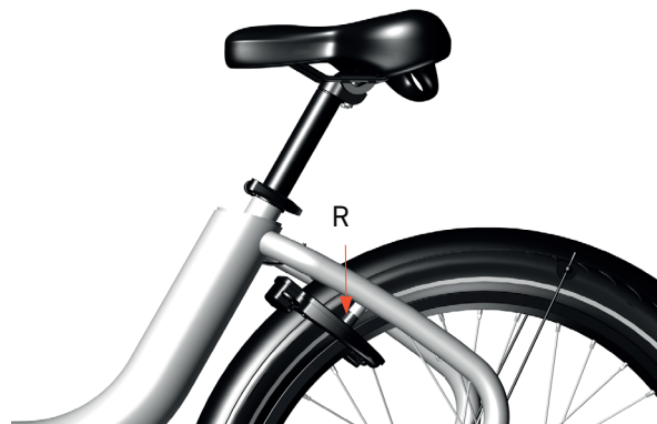
Afbeelding 38: De slotrubbers controleren
