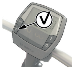
Image 21 : Mettre l'affichage sous et hors tension
