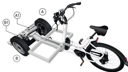
Image 32 : Dépose et pose d'un pneu avant
