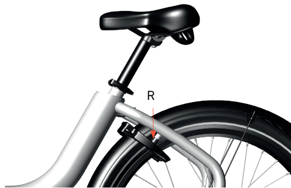
Abbildung 38: Überprüfen der Schlossgummis
