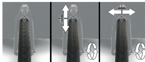
Abbildung 34: Seitenschlag am Hinterrad prüfen
